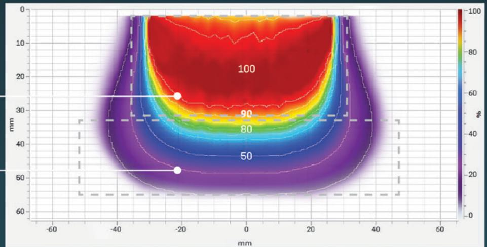
Isodose curve, applicator Ø 6 cm, 12 MeV, 0° bevel angle.
